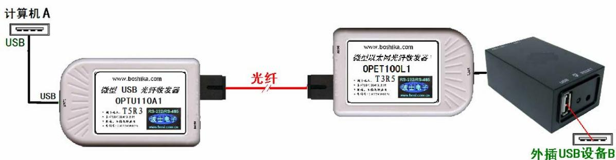
图 5 USB 远程光纤延长（单纤双向）
