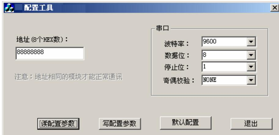
由于产品出厂时默认设置为（9600bps，N，8，1），所以如果用户的通信速率为 9600bps，格式为 N，8，1，那么就不需要进行配置设置了。波仕 RAD232L1 产品出厂时的地址编码均设为 88888888，一般是不用修改的，只有地址编码相同的 RAD232L1 之间才能够通信。
