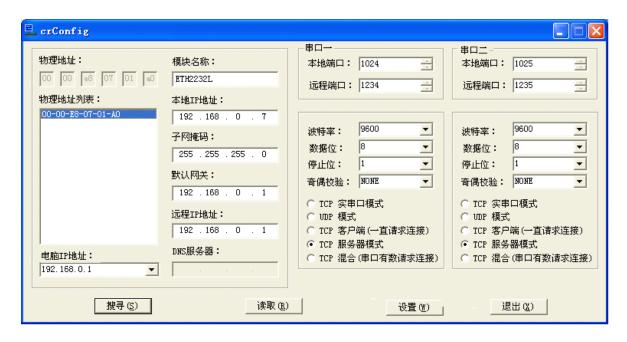
串口 1 与串口 2 的 IP 地址相同,为 192.168.0.7,均设置为"TCP 服务器模式","本地端口"分别为 1024(串口 1)和 1025(串口 2)。相应的,在 Test.exe 程序界面中,串口 1 的"远程端口"填 1024,串口 2 的"远程端口"填 1025,"远程 IP 地址"均为 192.168.0.7,波特率默认 9600。
