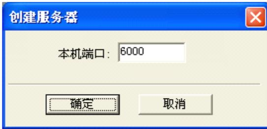
如果远端的 ETH232I 以太网-串口转换器设置正确，就会向本机服务器申请服务。这样就会在“本机 (192.168.0.109) : 6000”栏目下面显示“192.168.0.1: ××××”，其中一定有一行会收到 ETH232I 发出的数据并且显示出来。
